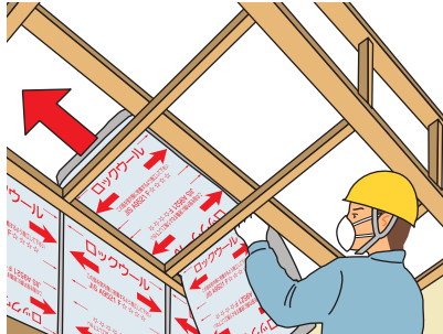
野縁上にアムマット施工中
