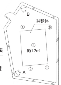
JIS A 1409 残響室法吸音率の測定方法
