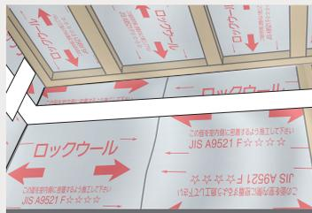
継ぎ目の重ねしろが下地材のある部分で30mm以上取れない場合
