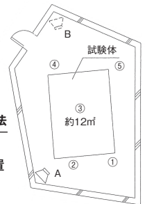
JIS A 1409 残響室法吸音率の測定方法 [A・B]スピーカー位置 [①～⑤]マイクロフォン位置
