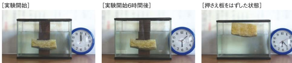
ロックウール(カットサンプル)を6時間水面下に浸し、6時間後に押さえ板を外しても耐水性が高いロックウールは浮かびます。
